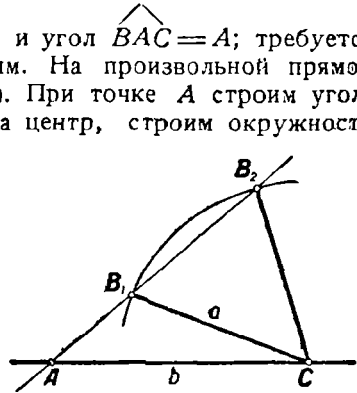
Черт. 45. Построение треугольника по двум сторонам и углу, противолежащему одной из них.
